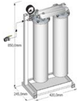
Doppelsystem AL600 für Öl mit Manometer Double system AL600 for oil with pressure gauge
