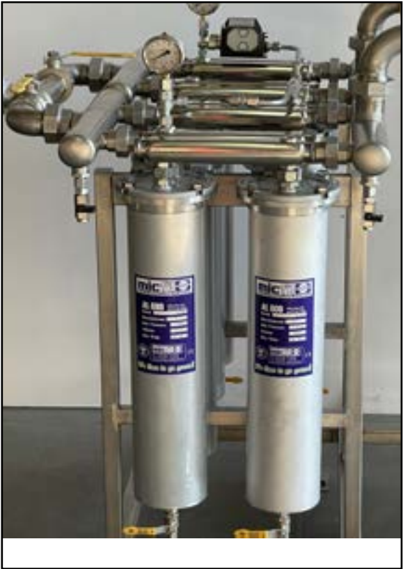
Montiertes AL600 Doppelsystem (links) Beispielsystem für hohe Durchflussraten: 8xAL600 System mit Pumpe (rechts). Installed AL600 double system (left). Example system for high flow rates: 8xAL 600 system with pump (right).
