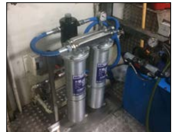
AL600 Doppelsystem mit WS800 für Diesel am Hauptmotor. AL600 double system with WS800 for diesel on the main engine.
